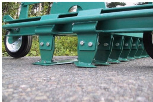
Hver av de fremre knivene er vinklet ca 15 grader.
