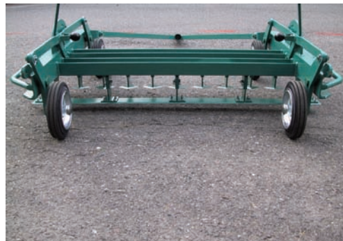
Den bakre kniven tar hånd om ugresset som har passert de fremre knivene.
